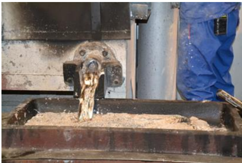
Obr. č. 8 Odpich roztaveného surového olova ze sifonu do formy
