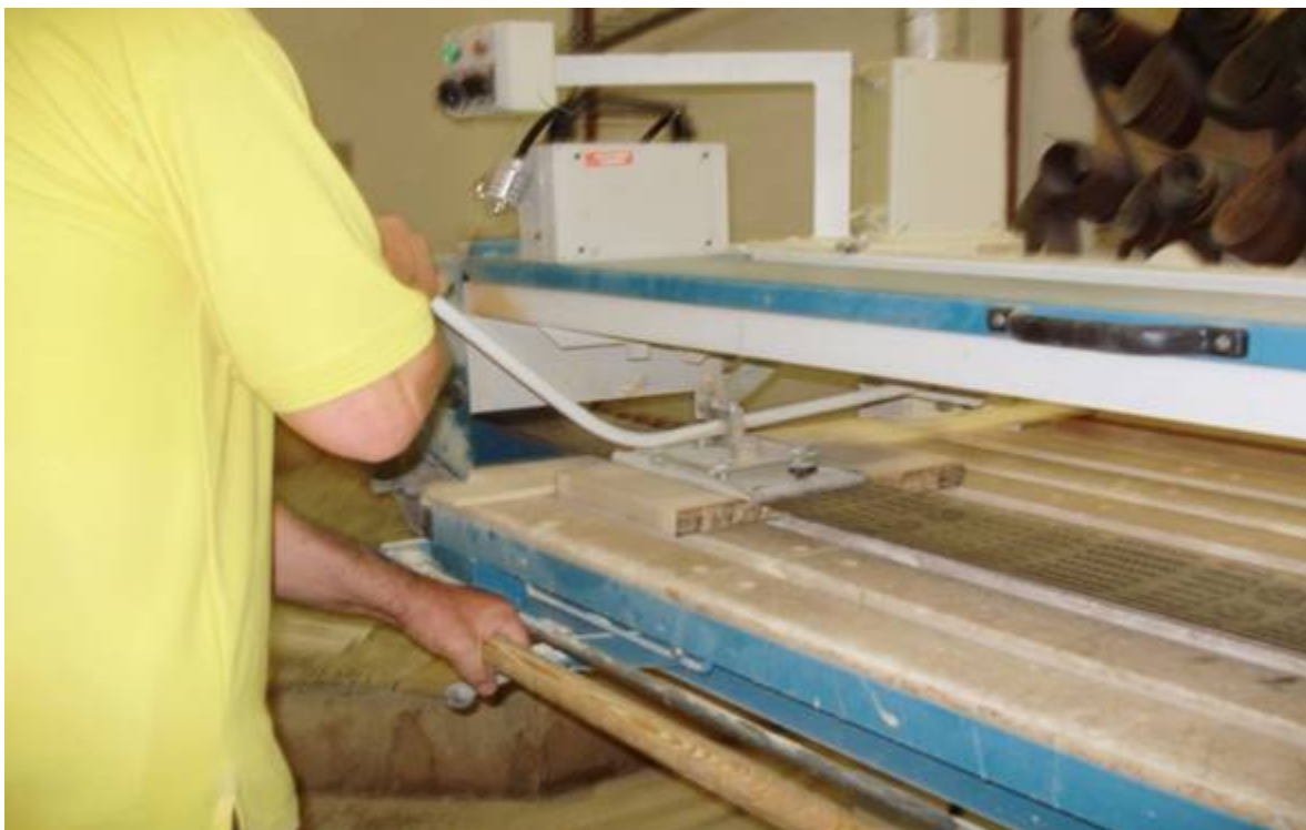
Obr. č. 1 Umístění měřící aparatury na separaci frakcí na pásové brusce
