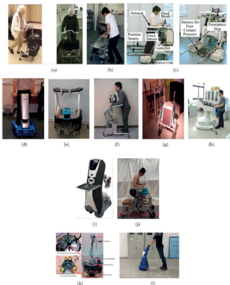
Obr. 1: Příklady inteligentních chodících kompenzačních pomůcek (a)PAMM b)RT–Walker c)Kai Walker d)Guido e) ORTW–II f) Intelligent Walker g)ANG h) Width–changeable Intelligent Walker i)Care–O–bot j)STS Walker k) iCane l) Cane RobotZdroj: Qingyang Yan, Jian Huang, Chunjing Tao, Xinxing Chen & Wenxia Xu (2019) Intelligent mobile walking-aids: perception, control and safety)
