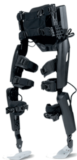
Obr. 2: ReWalk skelet (Zdroj: https://rewalk.com/ )
